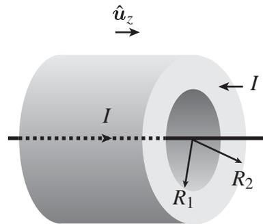
Halle el campo magnético en la región  $R_1 < r < R_2$ , donde  $r$  es la distancia al eje común de los conductores. Haga un dibujo mostrando una de las líneas de campo magnético para esa región.
