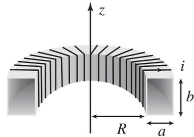
Suponga que las líneas de campo magnético en el interior del toroide son circunferencias paralelas al plano  $xy$  y con centro en el eje  $z$ . Calcule el campo magnético dentro del toroide e indique el sentido de las líneas de campo.
