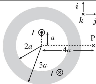
Encuentre el campo magnético que el conjunto produce en el punto P, el cual se encuentra en la línea perpendicular al eje del cilindro y al diámetro que pasa por el alambre, y a una distancia  $4a$  del eje. Expresar su resultado en la base cartesiana.
